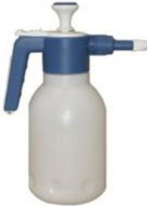
Ce pulvérisateur à pression préalable 1.5l est **résistant** aux produits chimiques avec ses joints viton. Léger et pratique avec sa buse réglable de jet droit à brouillard. Le levier peut être bloqué pour un jet continu ou en position de sécurité. Il est livré avec une buse mousse.
